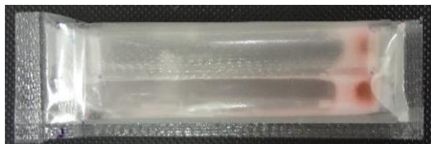
図 2.1.2-6 航空機輸送試験後の供試体
