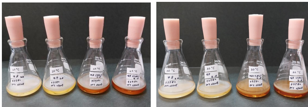
図 2.2.1-1 植菌後 30 日目のセルロース合成の様子 (左: 培養温度 20°C、右: 培養温度 30°C)
