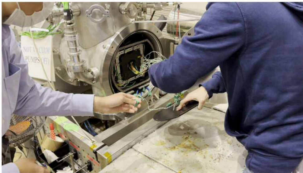
図 5.1.2.1 EM の熱真空試験の様子
