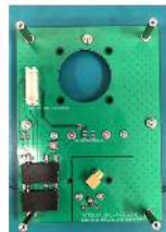
アンテナパネル裏面
