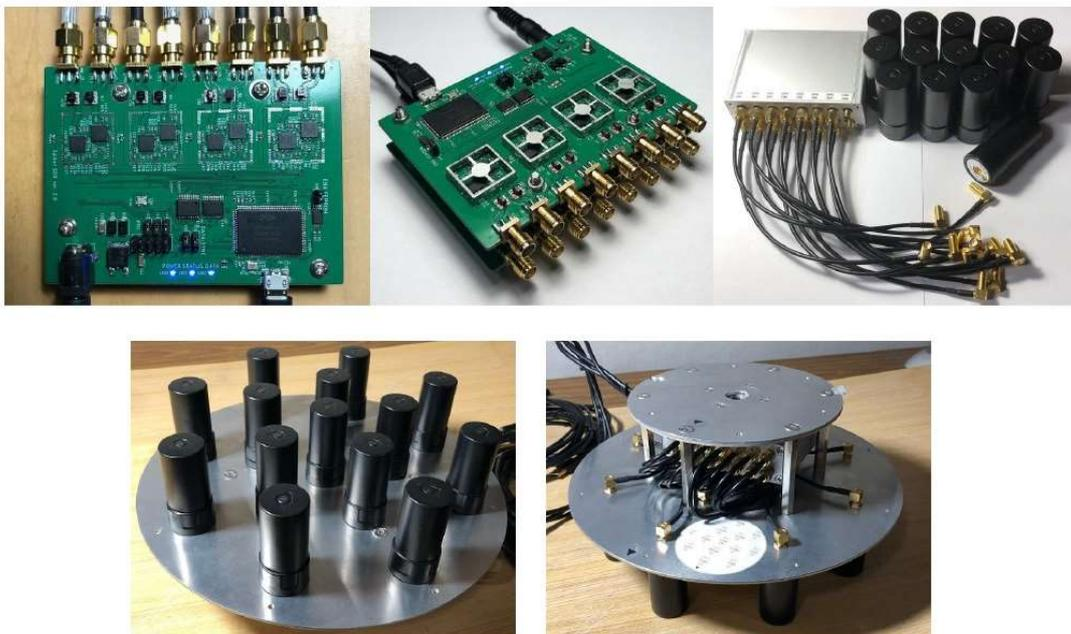
【図 2.1.3f 研究開発用のアレイアンテナの制作】
