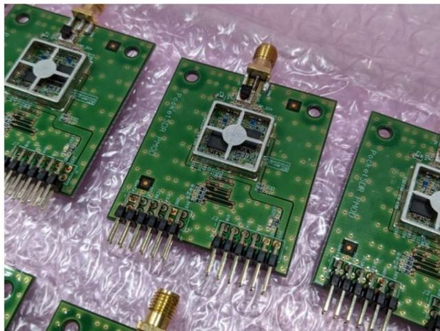
【図 2.1.1.1 : FPGA 用フロントエンド基板】
