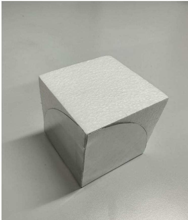
図 3: 発泡スチロール製の立方体に厚み 0.2mm のアルミ平板を張った簡易的なコーナーリフレクタ。図は扇形を組み合わせたもので一辺の長さは 10cm。
