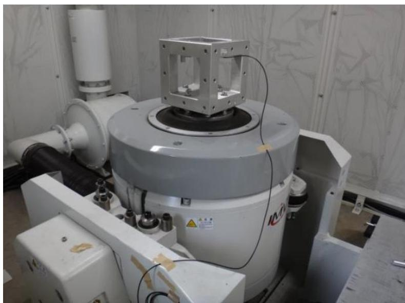
図 2.1.12 高周波振動装置と立方体治具
