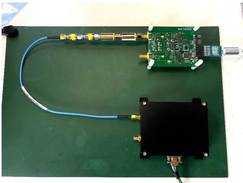
図 2.2.16 IoT 通信装置 EM の送受試験の様子
