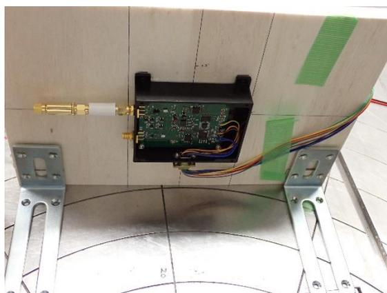
図 2.2.13 IoT通信装置 EM基板に対するTID試験
