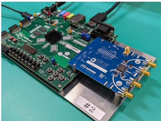
図 2.1.8 AD9361 の SEE 試験供試体
