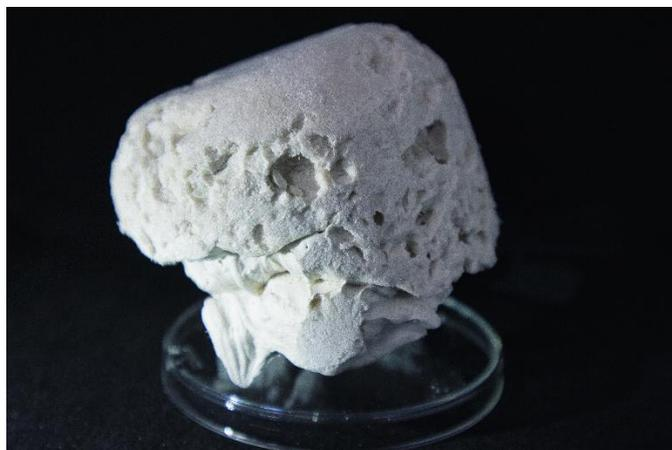
図 3 複合反応系から得られたセルロースから成るブロック
