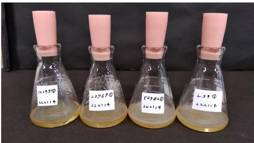
図 21 酢酸菌植菌後 28 日目の様子(HS 培地、培養温度:30°C)
