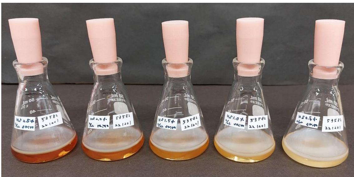
図 26 様々な Yeast extract 濃度の HS 培地で培養した際の様子(培養温度:20℃)
