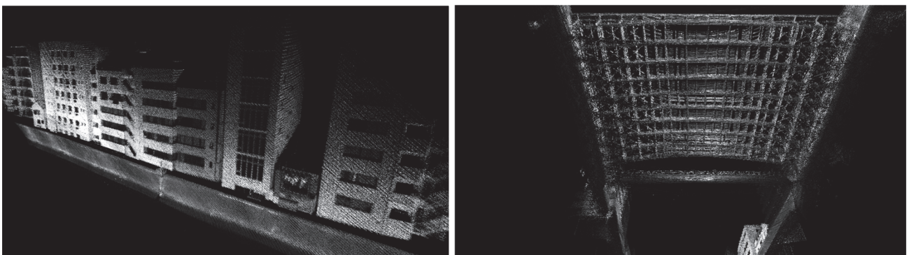
図 20. CLAS/SLAM での高密度点群生成例 (図左: 護岸周辺, 図右: 床版周辺)
