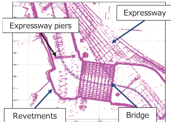
図 19. CLAS/SLAM での船舶軌跡推定と疎点群生成例
