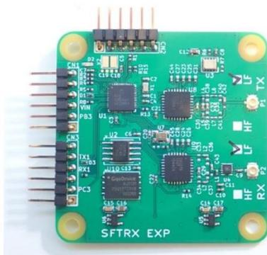
図 2.2.5 試作したIoT通信装置の送信/受信部
