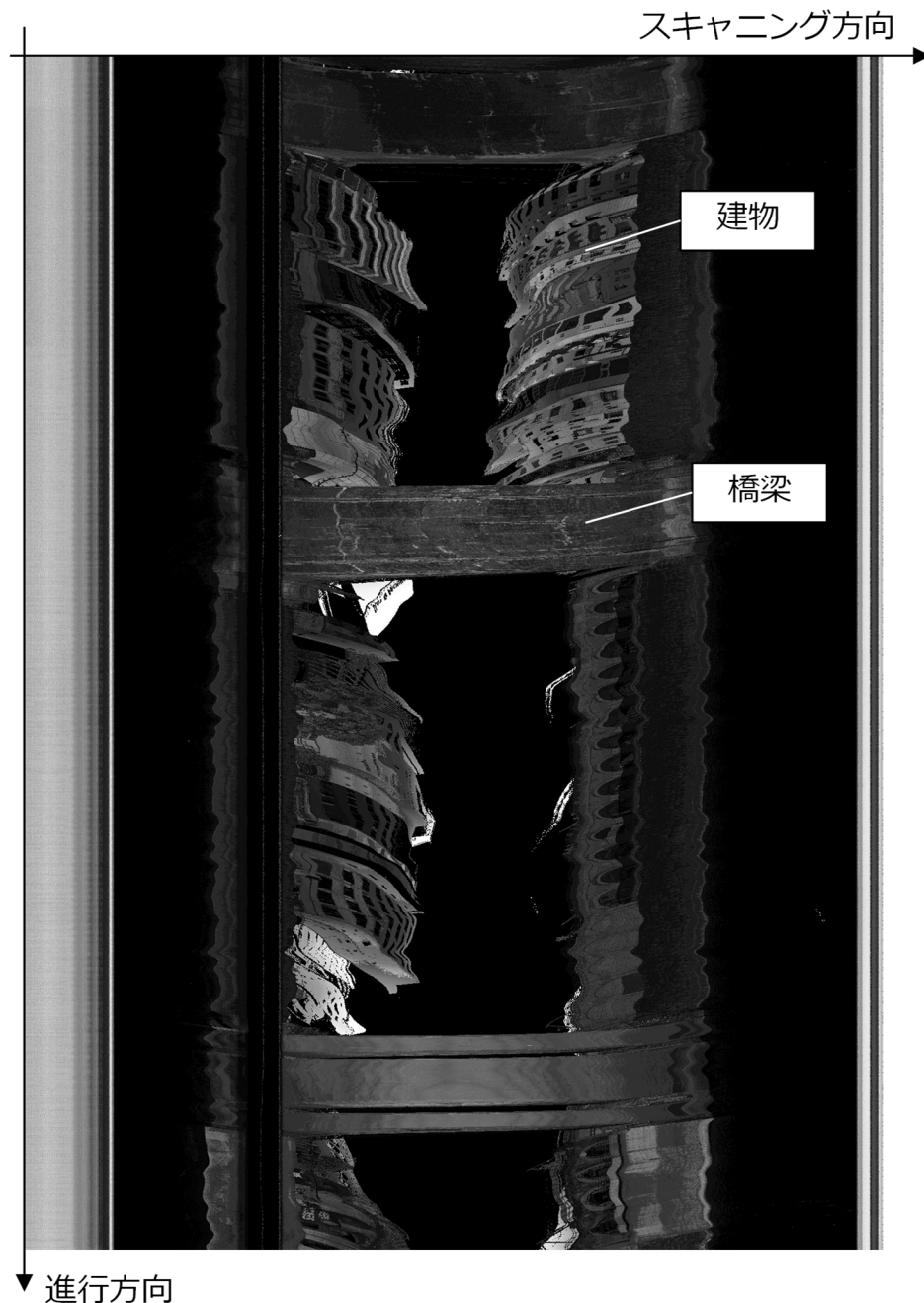
図 3-7. 斜めスキャニングデータのレーザ反射強度値の画像化結果
