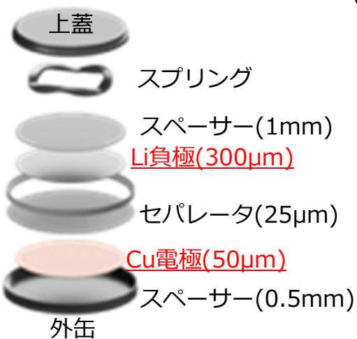
コイン電池の構造
