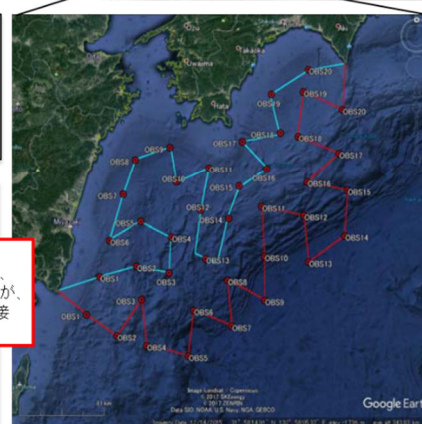
▲南海トラフ海底地震津波観測網（N-net）の設置図（イメージ）
