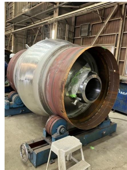
写真3 肉厚95 mmの推進剤高圧ランタンク内槽
