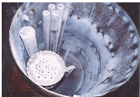
原子力機構大洗原子力工学研究所での炭酸塩化処理後の機器内部のナトリウム炭酸塩（白色薄膜状生成物）の付着の様子
