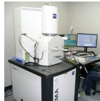
3次元再構築用電子顕微鏡（生理研に3台設置）
