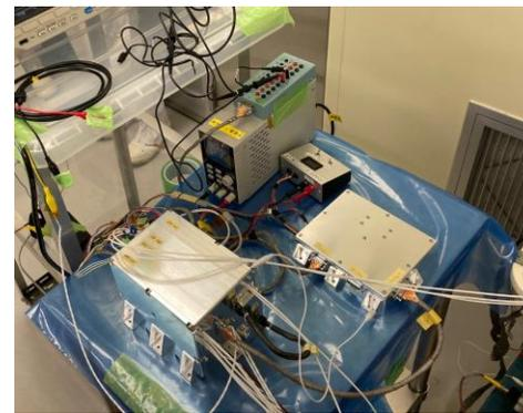
真空チェンバー内に設置したアナライザー(左)と真空チェンバーの近くに設置した電子回路部の写真
