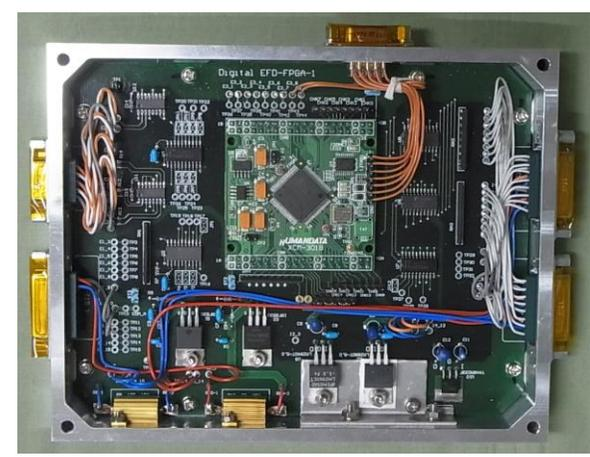
電場計測器のデジタル信号処理部の回路基板
