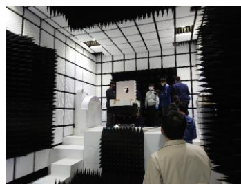
衛星通信の講義・実習の様子 (左: 6面電波無響室でのアンテナパターン実習)
