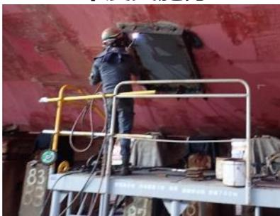
船底外板腐食箇所切替
