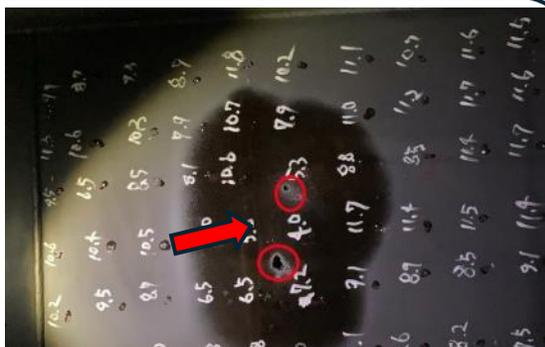
燃料タンク天井 板厚計測結果
