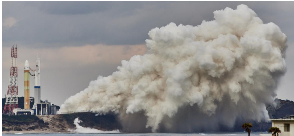
1段実機型タンクステージ燃焼試験(CFT)
