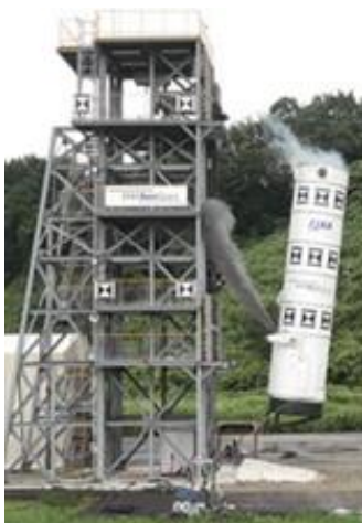
SRB-3 分離試験・実機大燃焼試験 燃焼試験：3回
