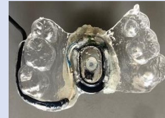
【図1】スピーカー埋め込みマウスピース
