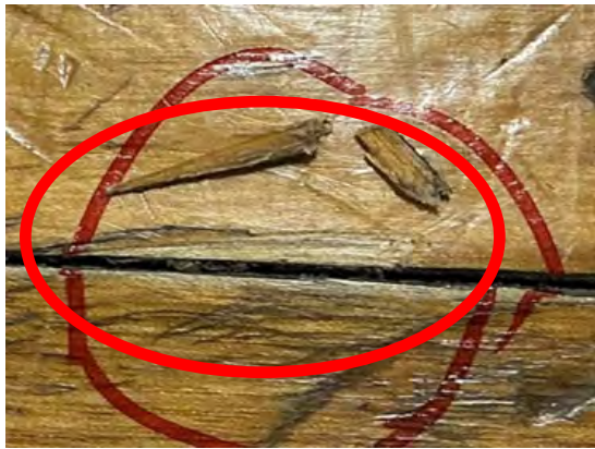
床板が剥離した箇所及び剥離した木片 (生徒に刺さった木片は左側のもの 長さ：1.7 cm)
