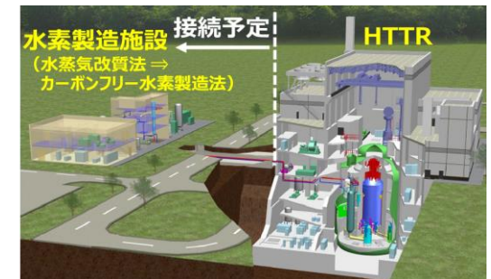
HTTRと水素製造試験施設の接続予定図
