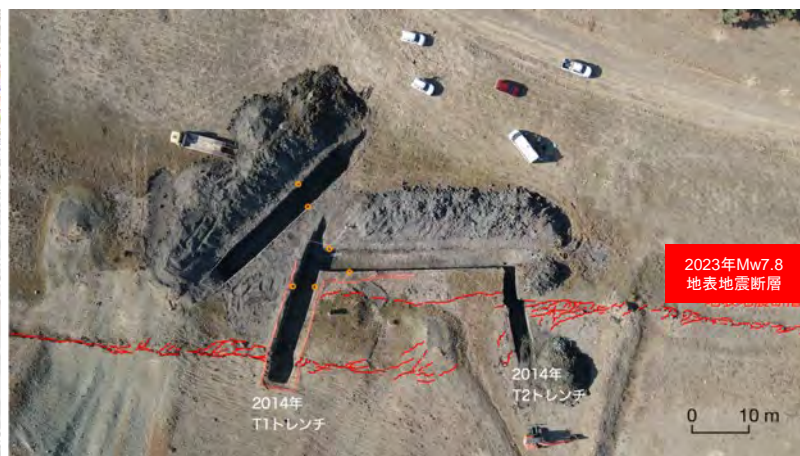
2014年トレンチ(T1およびT2)の再掘削と3Dトレンチ調査
