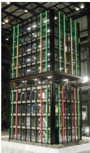
図2 E-ディフェンスでの10階建てオフィスビル実験
