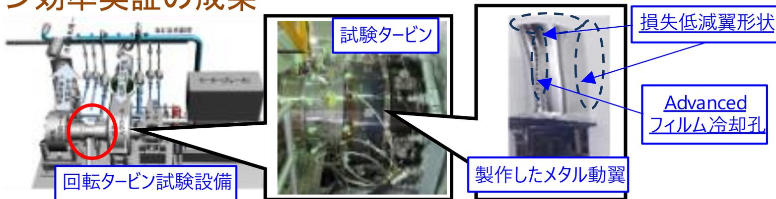
図1 タービン効率実証（回転タービン試験）と製作した実証用動翼
