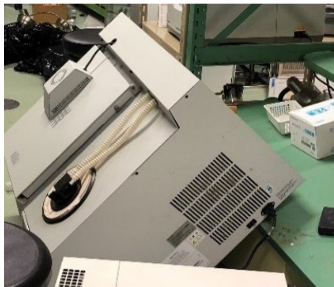
地震により遠心濃縮装置が故障
