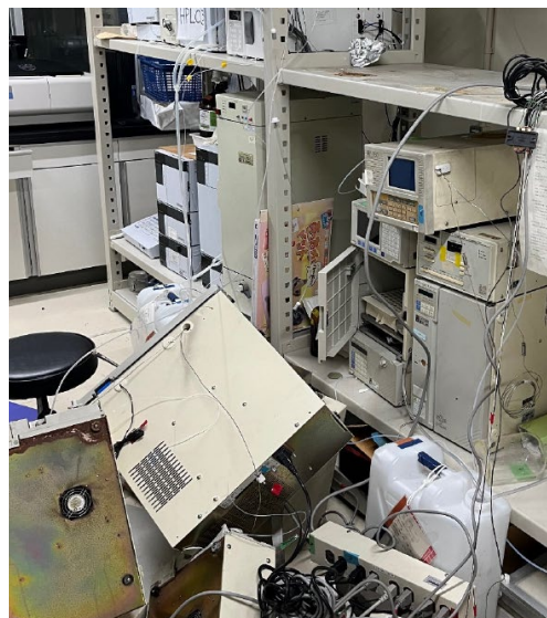
地震により高速液体クロマトグラフが破損
