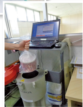
(上、右) 給食に使用するものと同一検査用の食材を刻んで計測器にかけています。
