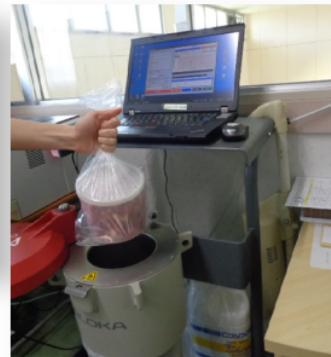
(中央、右) 給食に使用するものと同じ検査用の食材を刻んで計測器にかけています
