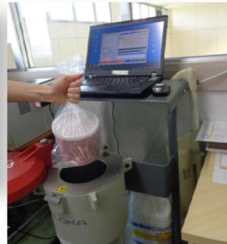
(中央、右) 給食に使用するものと同じ検査用の食材を刻んで計測器にかけています
