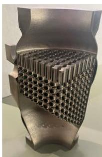
効率的熱交換器の試作例
