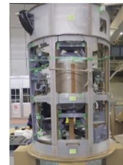
後部胴体構造の実スケールモックアップ。搭載機器の組立手順を確認
