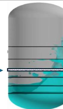
メッシュがない場合、液体が飛散し、加圧ガスの温度・圧力が低下
