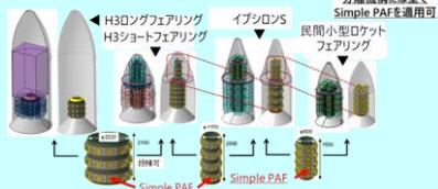
衛星の汎用搭載構造の例
