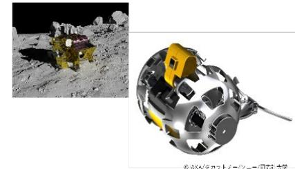
SLIMに搭載した変形型月面ロボット SORA-Q
