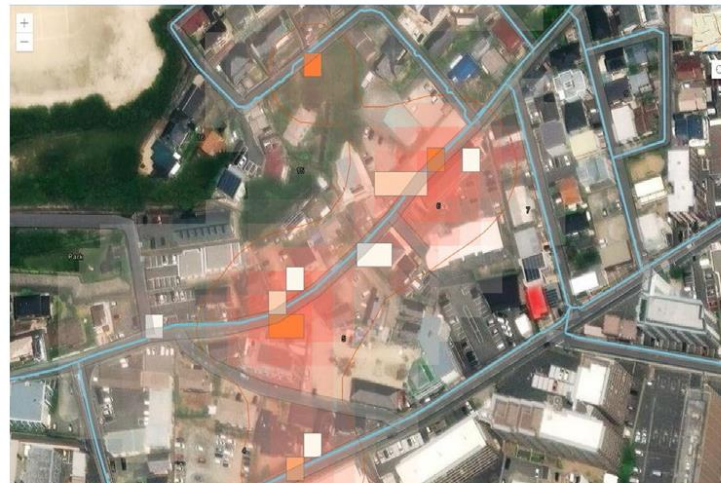
人工衛星画像を活用した漏水調査イメージ（漏水リスクエリアを赤色で表示）
