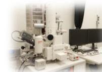
研究装置の例：高分解能走査電子顕微鏡
