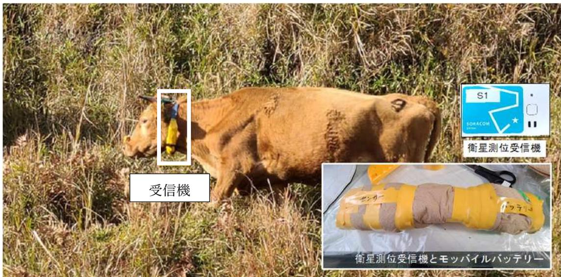
図 3.1.9. センサを放牧牛に装着する装置の現状版
