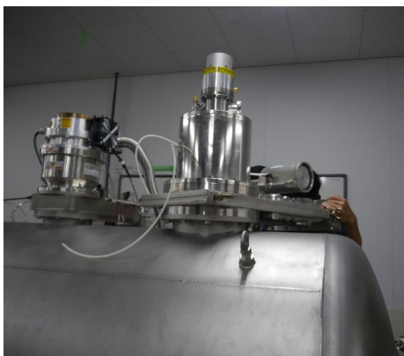
図 1-11 取り付けしたクライオポンプ
