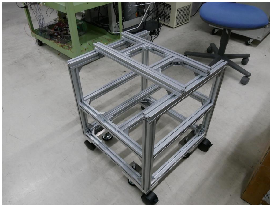
図 2-12 組み上げたカソード実験系固定フレーム外観
