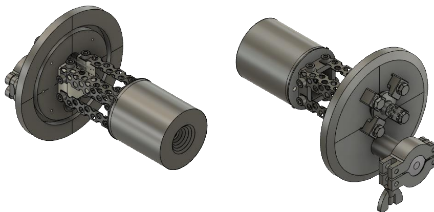
図 2-11 カソードとフランジが固定されている様子
