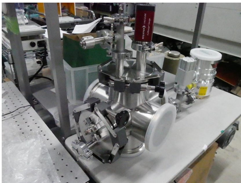
図 2-13 6 方クロスに圧力計，カソード固定フランジを取り付けた様子
