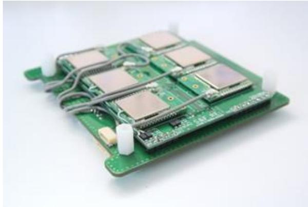
図 3.4 ドップラーシフト対応衛星搭載 S&F 受信機
