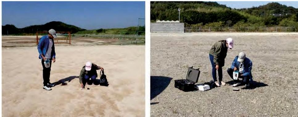
図6 分光放射計による評価パターン周辺の計測
