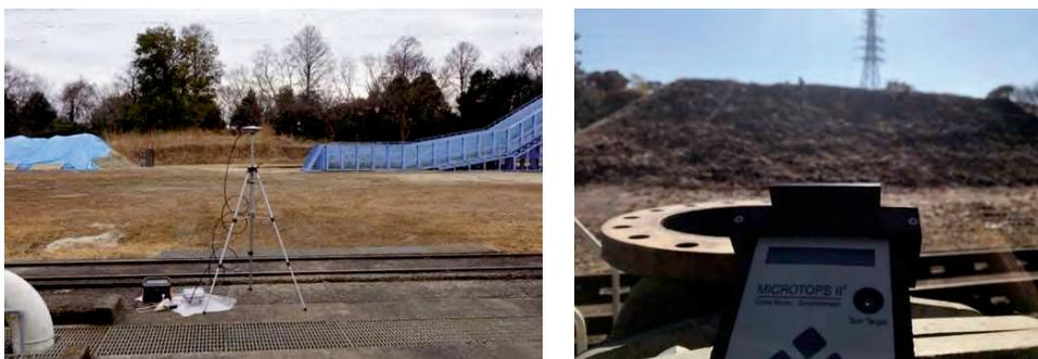
図 10 RTK-GNSS 計測 (左) と太陽光フォトメータ計測 (右)
