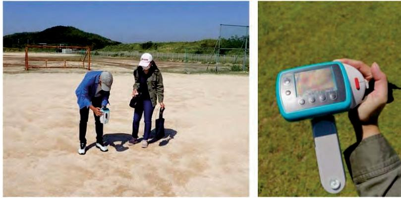
図 11 スペクトロメータによる計測の様子
