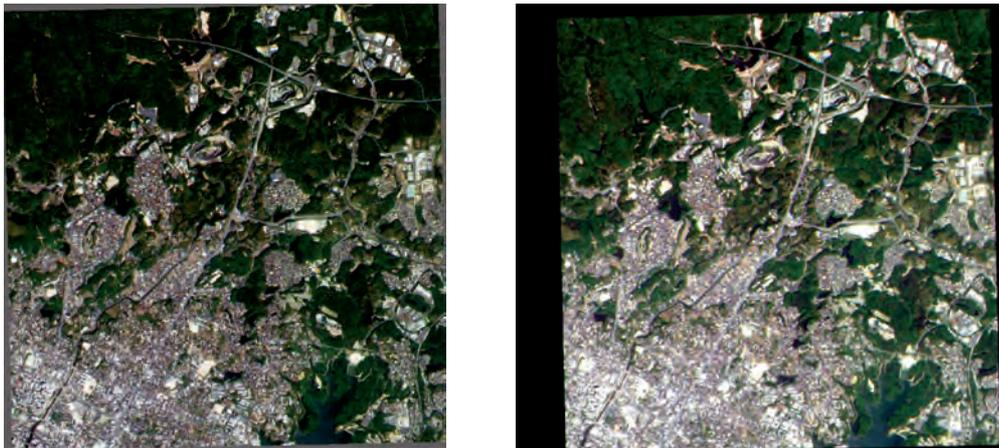
図 31 バンド間レジストレーションの校正前（左）と校正後（右）
