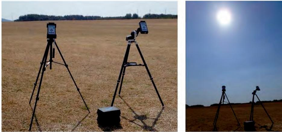
図 13 太陽光フォトメータ（左）とオゾンメータ（右）による計測の様子
