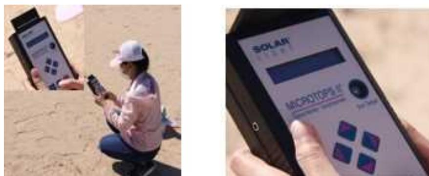
図 14 太陽光フォトメータによる計測
