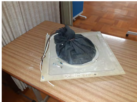
落下したスピーカー 大きさ：30cm×30cm×10cm（約 900g）
