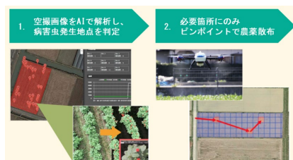
ドローンを使ったピンポイント農薬散布により コストと環境負荷を軽減
