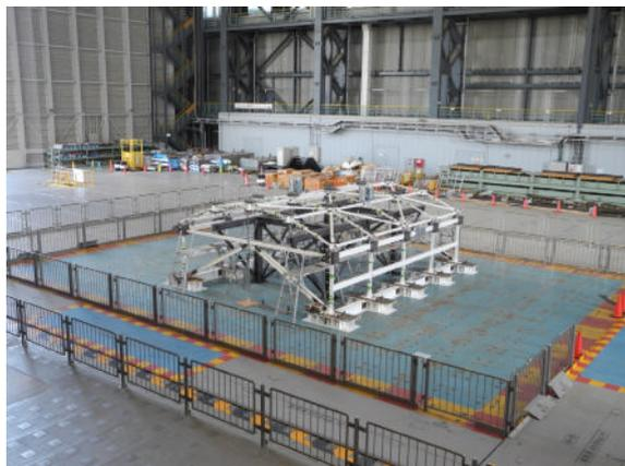
大規模空間建物の地震損傷過程の解明や対策技術の効果確認のため、令和5年7月から8月に実施したEーディフェンス震動台実験の様子
