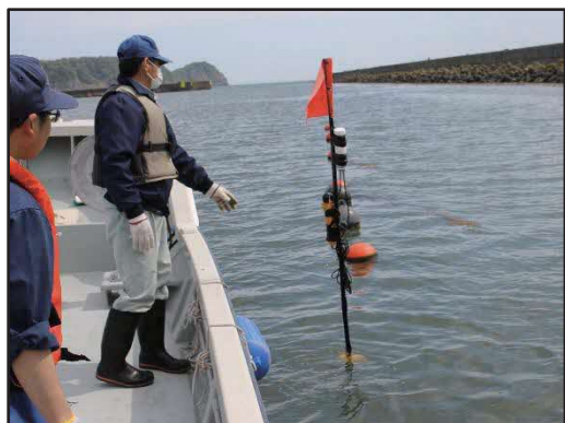
垂下施設にスマートブイを設置している様子
