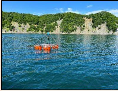
厚岸湾に「うみログ」を設置し、リアルタイムで水温、塩分、流速、有害プランクトンの値や海面の様子を確認できるようになった。
