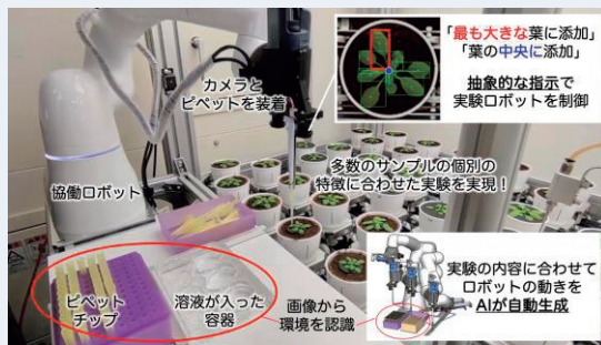
■ 第1-4-6図 / 見て考える自動実験ロボットと植物へのきめ細かな液体添加
