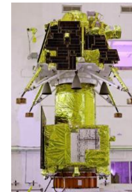
推進モジュール 2,148kg (写真は着陸機モジュールを 上部に搭載した状態)
