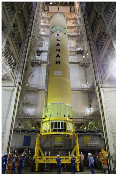
2024年4月2日 1段機体射座据付け(VOS)
