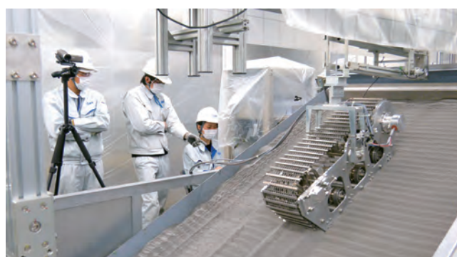
JAXA調布航空宇宙センターにおける月極域探査機 LUPEX（Lunar Polar Exploration）ローバの走行系試験（1輪登坂試験）の様子（撮影2023年2月） ©JAXA
