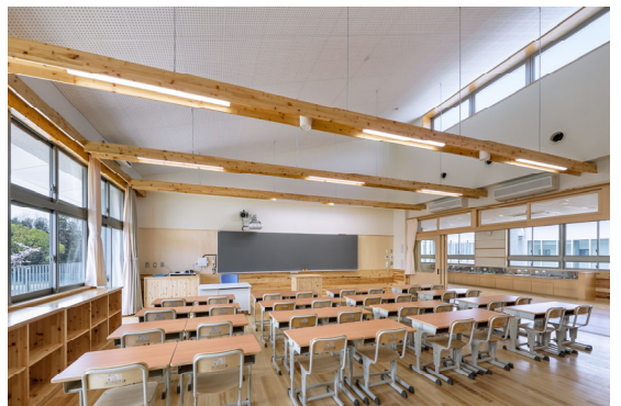
明るさセンサーを導入し、LED照明の 制御を行い、省エネを図っている。
