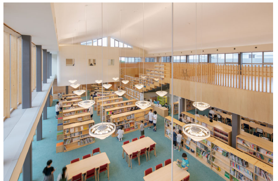
ハイサイドライトによる自然採光・自然換気
