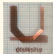
(i-SB法 ® でCuシード層を形成)したF-PIフィルム上に形成した微細配線(提供：太陽ホールディングス㈱)
