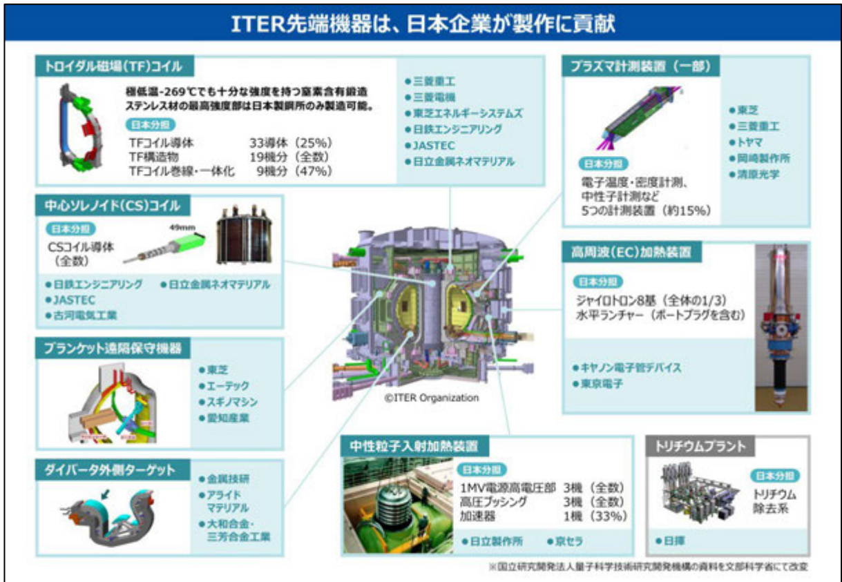
図10. ITER 計画における日本調達機器の例
