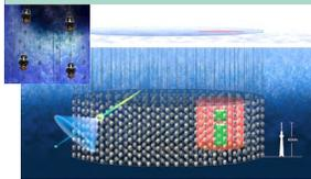
南極点直下に設置したIceCube検出器を世界15か国の連携により高度化し、世界最大のニュートリノ観測装置により高エネルギー宇宙ニュートリノの高感度観測を行う。電波からガンマ線まで分布する電磁波及び重力波との統合観測によるマルチメッセンジャー天文学を展開し、宇宙線の統合的理解、遠方宇宙や天体内部の探求に貢献する。
